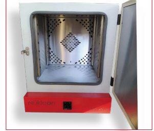
Homojen ve kararlı ısı dağılımı için fanlı iç hazne
